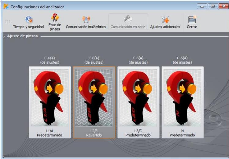
Fig. 36. Cambio de fase de pinzas.
